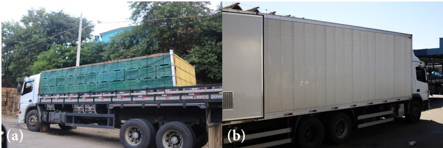
Figura 10. Transporte de tomates por caminhões: caminhão com lona (a); caminhão baú climatizado (b). Foto: Juliana Sanches.
